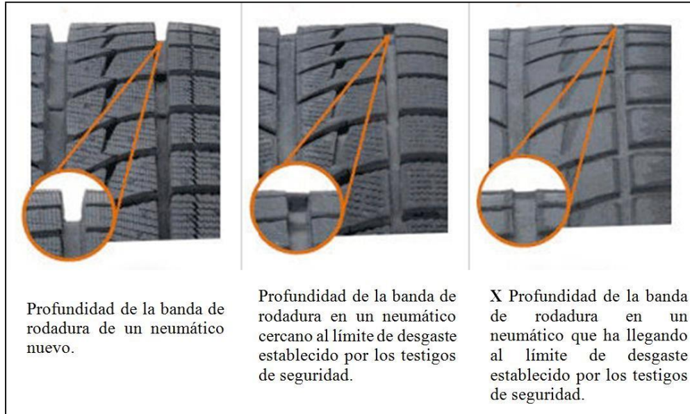
Figura 5.38 Evidencia de desgaste en testigo de seguridad en un neumático.
